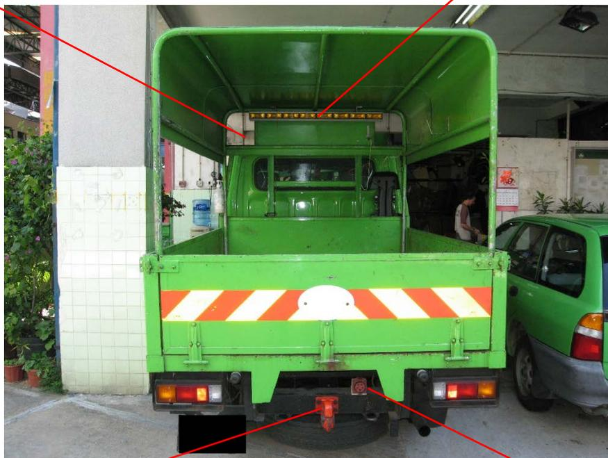
3. Instalar, na parte traseira do veículo, um gancho de reboque com travão (Ítem IV).
